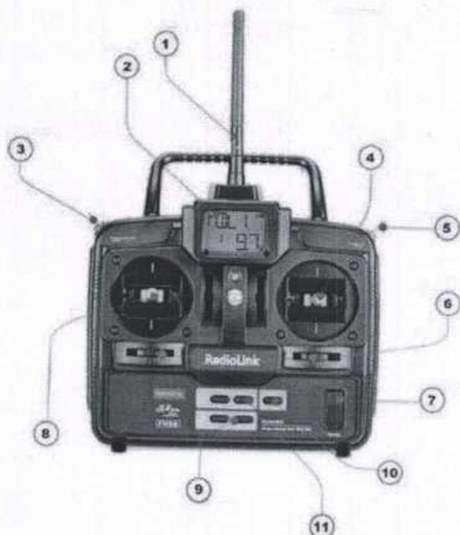
Варианты: Экран управления, Антенна, Ручка управления, Управление скоростью движением вперёд/назад (тангаж), Управление влево/вправо (крен), Флип (поворот на 360, Вкл./Выкл., Ручка управления оборотами двигателя и разворот вокруг своей оси (рысканье), Переключатель режимов, Кнопка выбора, Кнопка введения данных, Триммер.
