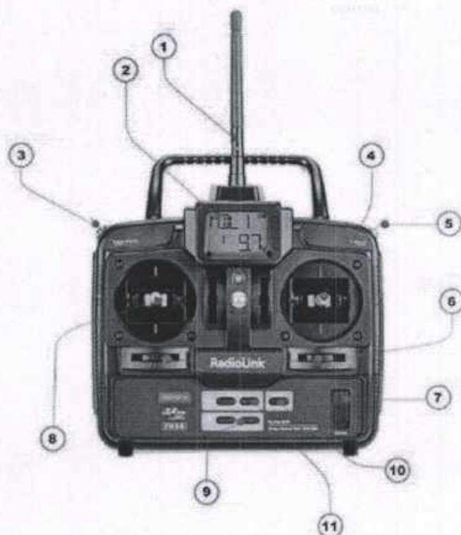
Варианты: Экран управления, Антenna, Ручка управления, Управление скоростью движением вперед/назад (тангаж) и влево/вправо (крен), Флип (поворот на 360, Вкл./Выкл., Ручка управления оборотами двигателя и разворот вокруг своей оси (рысканье), Переключатель режимов, Кнопка выбора, Кнопка введения данных, Триммер.
